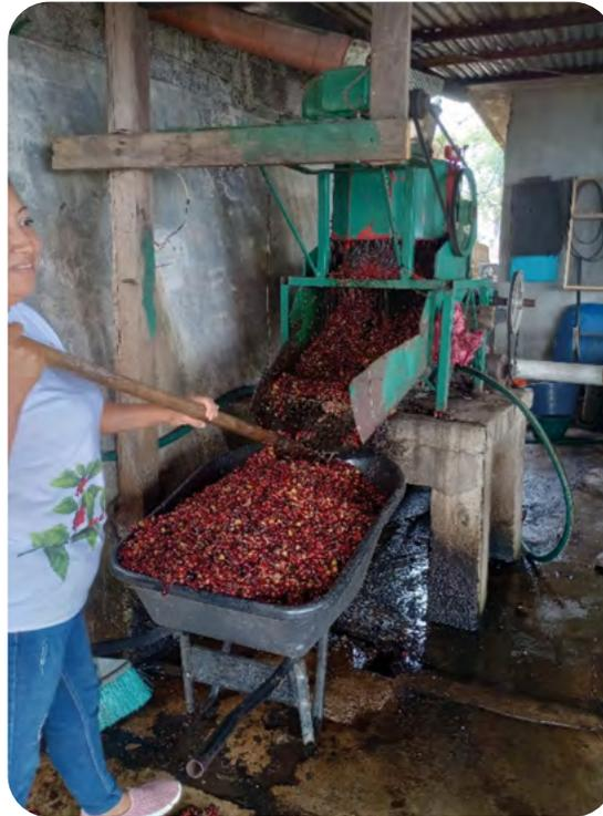
**Figura 9. Despulpado de café en el beneficio húmedo.**
