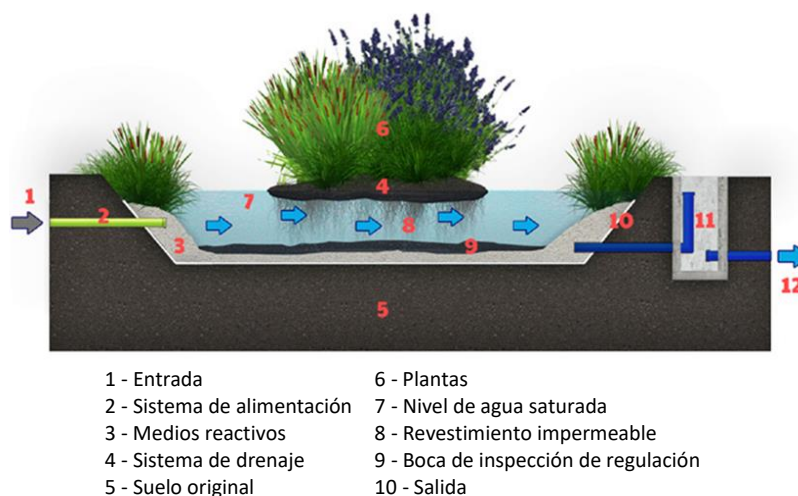
Figura 25. Corte esquemático humedal flotante, componentes del humedal
