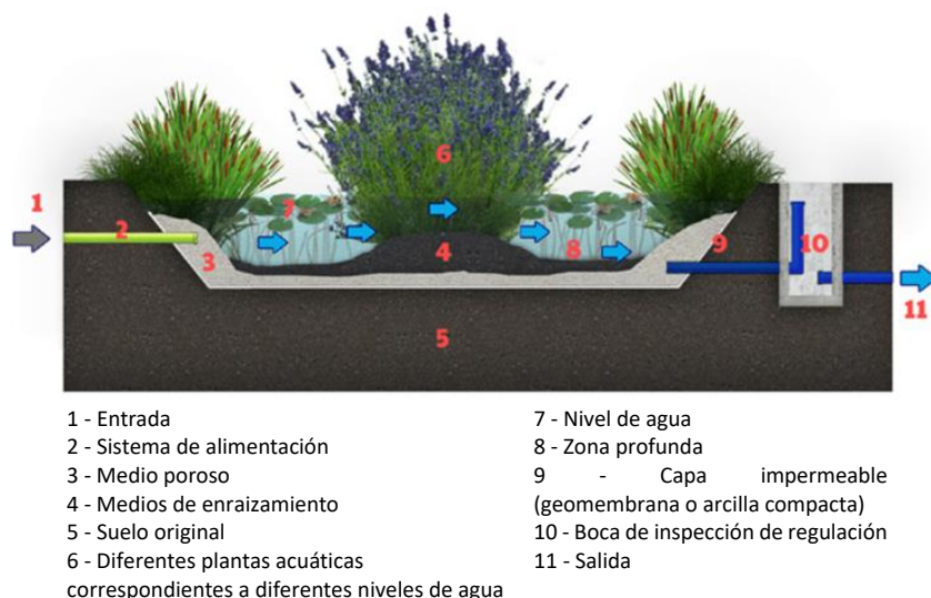
Figura 30. Corte esquemático humedal flujo superficial, componentes del humedal.
