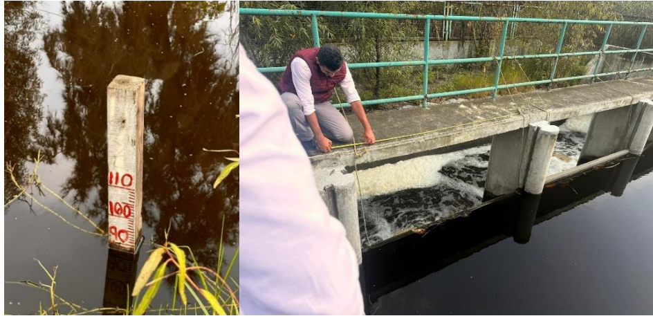
Figura 9 Regleta para medir el tirante sobre el Canal Japón y personal del equipo técnico realizando mediciones de la obra de control.
