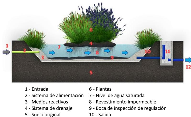
Figura 26. Corte esquemático humedal flotante, componentes del humedal
