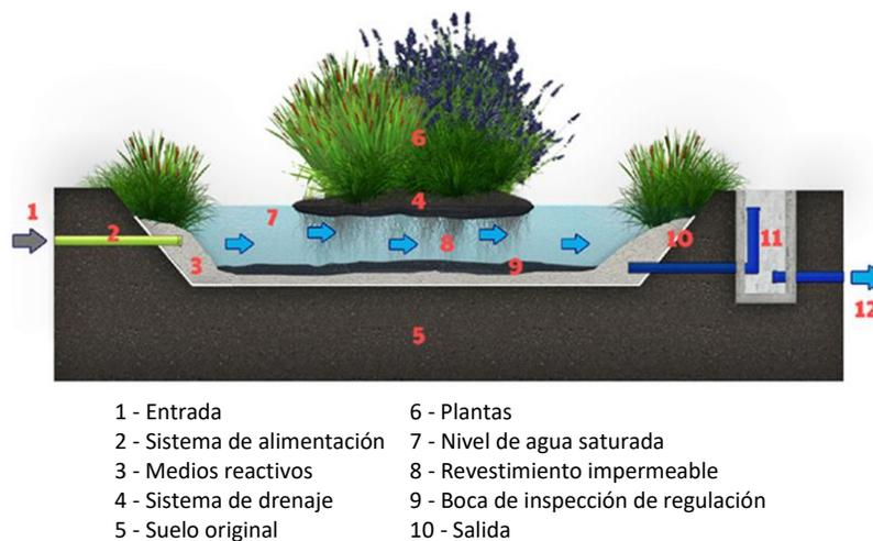
Figura 40. Corte esquemático humedal flotante, componentes del humedal
