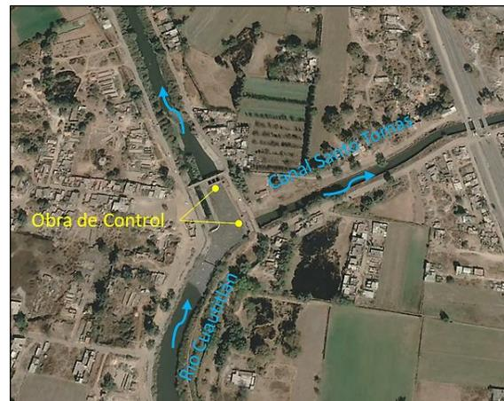
Figura 19. Derivación del río Cuautitlán hacia la laguna de Zumpango por el canal Santo Tomas.
