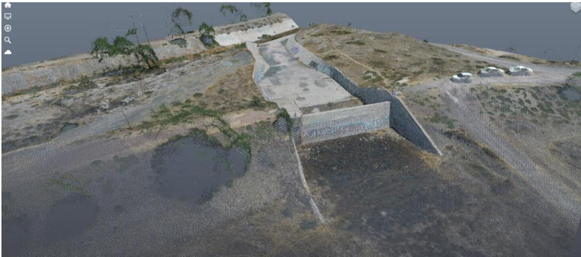
Figura 9 Vista tridimensional a partir de nube de puntos del vertedor de excedencias.
