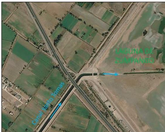
Figura 18. Descarga del canal Santo Tomas en la laguna de Zumpango.
