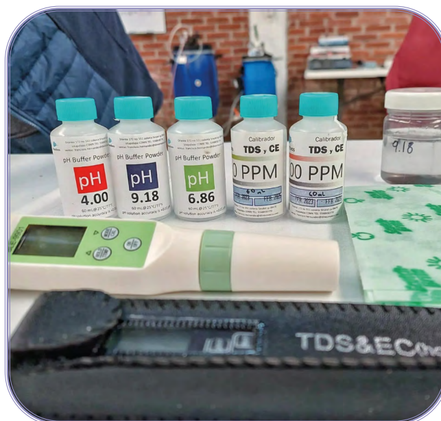
Figura 14. Soluciones para calibrar potenciómetro y medidor de TDS
