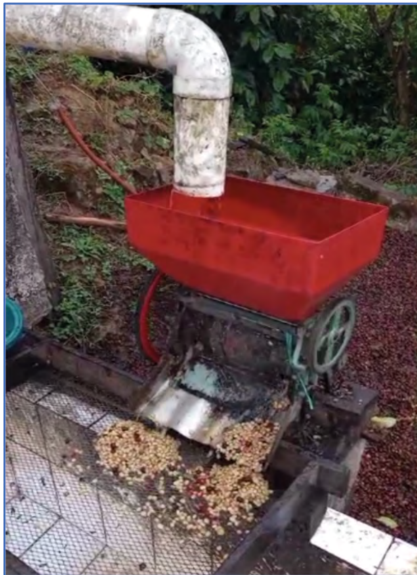
Figura 5. Proceso de despulpado del fruto de café en su estado de cereza.
